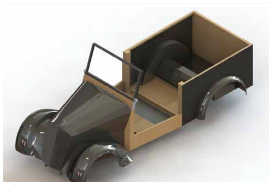
Odtworzone metodami inżynierii odwrotnej i uzupełnione zamodelowanym przez autora wyposażeniem nadwozie samochodu Farmerwagen
