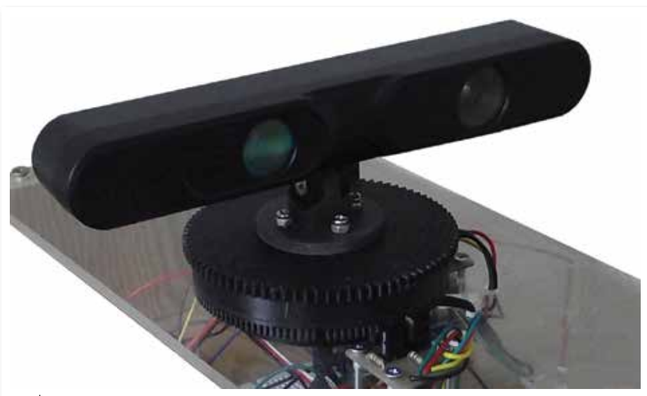
Zaprojektowana przez Przemysława Kordowskiego obrotowa głowica z czujnikiem
