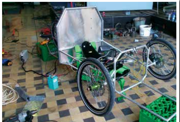
Montaż pojazdu po zaadoptowaniu nowej, lżejszej ramy
