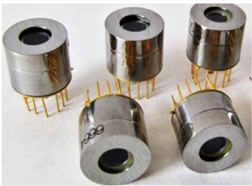
Nagrodzone złotym medalem Geneva Inventions 2015 Detektory wysokotemperaturowe dla zakresu średniej podczerwieni (5 \mu\text{m} ) o krótkiej stałej czasowej
