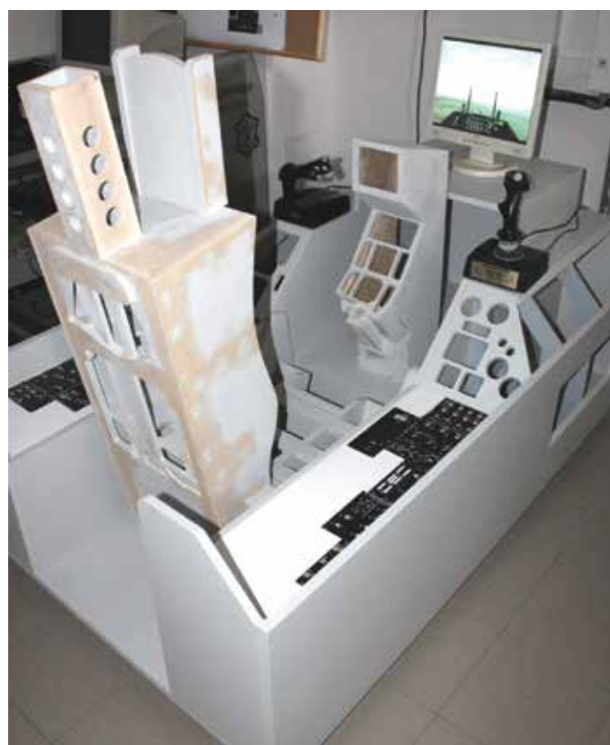
Symulator kokpitu samolotu F-16C podczas testowania i prac wyposażeniowych
