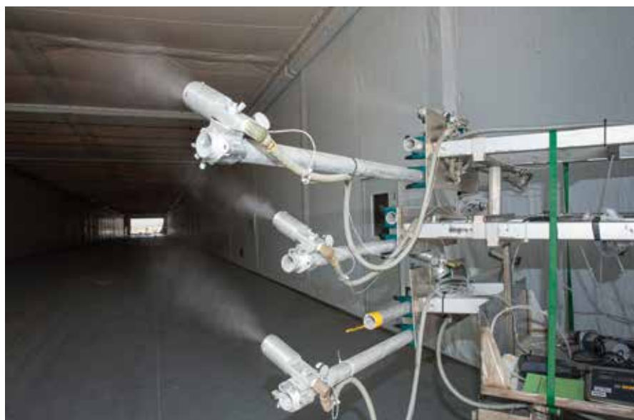
Rozpylanie aerozolu wewnątrz komory Joint Ambient Breeze Tunnel (JABT) o długości ok. 100 m, która służy do rozpylania większych ilości aerozoli chemicznych i biologicznych wraz z uzyskiwaniem efektu kontrolowanego ich przemieszczania wzdłuż komory
