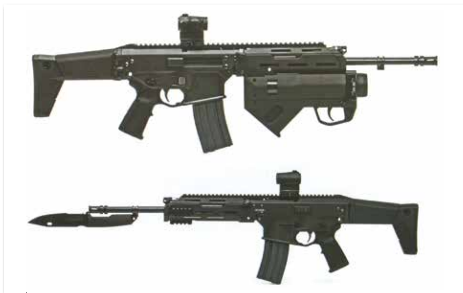
Karabinek standardowy w układzie klasycznym systemu MSBS-5,56 wraz z granatnikiem podwieszanym (góra) oraz nożem-bagnetem (dół)
