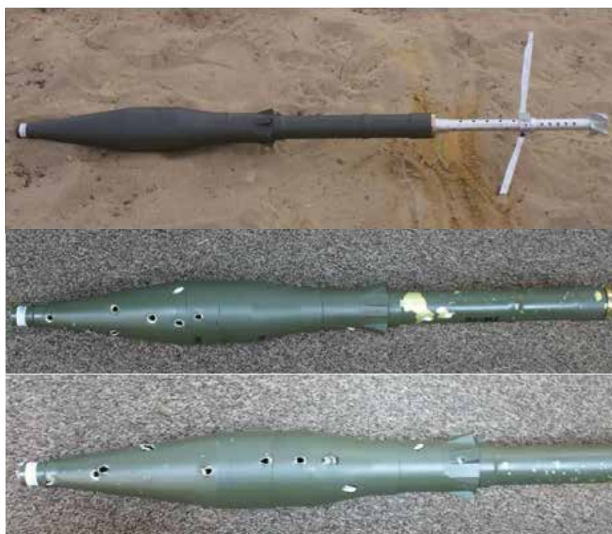
Skutki oddziaływania odłamków pochodzących z destruktora, z pociskiem typu RPG
