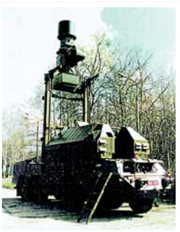
Stacja rozpoznania pokładowych urządzeń radioelektronicznych MUR-20, przy współpracy z PIT S.A.
