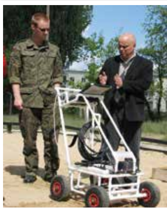
Impulsowy radar penetracji gruntu podczas badań poligonowych w Laboratorium Sensorów Teledetekcyjnych
