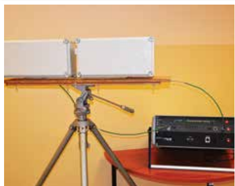
Demonstrator radaru szumowego pasma X dla systemu obrony aktywnej przed pociskami przeciwpancernymi
