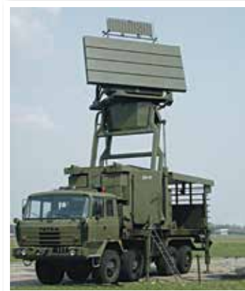
Radar 3D średniego zasięgu TRS-15 ze stosem wiązek do odbioru, producent PIT S.A. (obecnie Bumar Elektronika)
