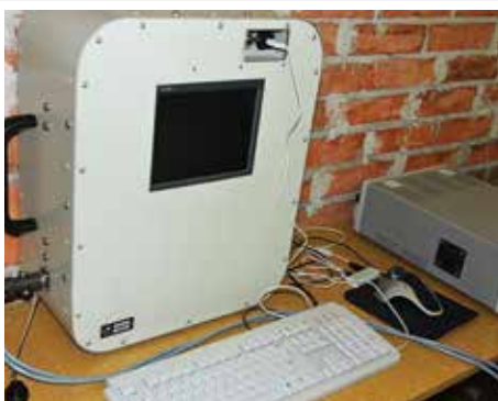
Lokalizator istot żywych ukrytych za ścianą wykorzystujący szerokopasmowy radar szumowy
