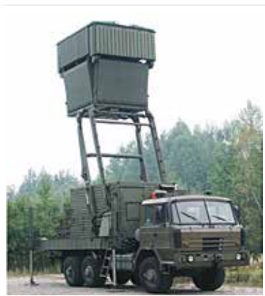
Radar 3D średniego zasięgu TRC-20 z elektronicznym przeszukiwaniem przestrzeni obserwacji wiązkami ołówkowymi, producent PIT S.A.
