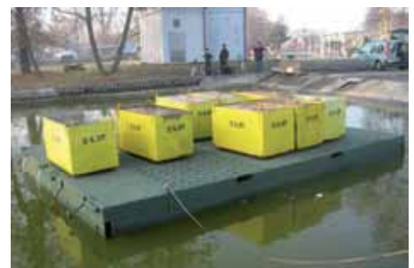
Próba wyporności i stabilności zestawu dwóch modułów mostu kasetowego
