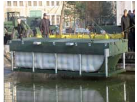
Próbne wodowanie modułu mostu kasetowego z pływakiem wypełnionym gazem
