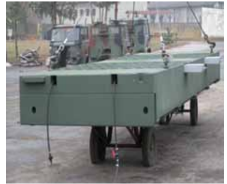
Widok ogólny pojedynczego modułu kasetowego mostu pontonowego w stanie transportowym
