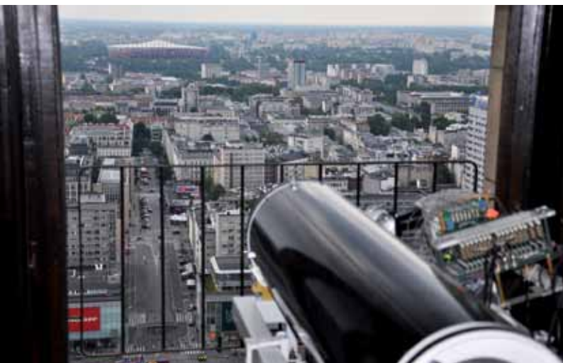
Specjaliści z IOE monitorowali rejon Stadionu Narodowego oraz strefę kibica przy użyciu dwóch systemów lidarowych: bliskiego i dalekiego zasięgu
