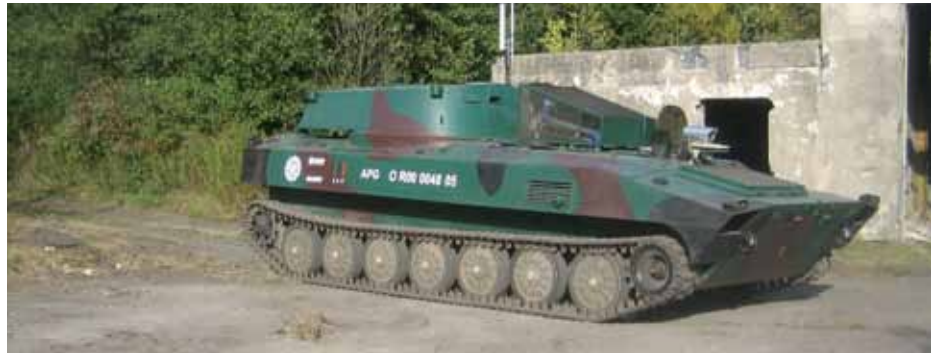
Pojazd bezzałogowy na bazie czołgu
