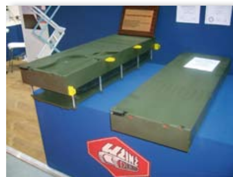
Modele dwóch kaset mostu pływającego wykonane w skali 1 : 5
