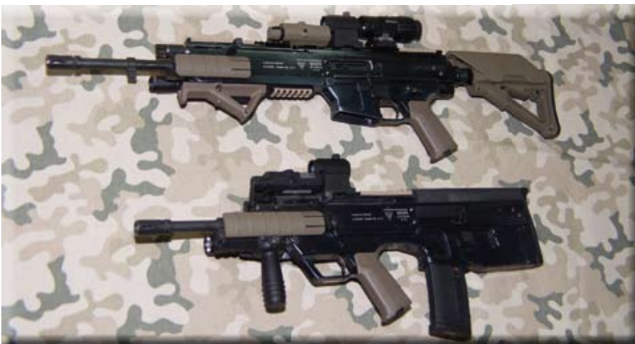
Demonstratory technologii karabinków podstawowych kalibru 5,56 mm w układzie kolbowym (góra) i bezkolbowym (dół)
