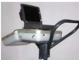
Mobilne stanowisko do badań widmowych współczynników odbiciowych
