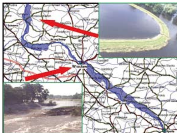
Uszkodzenia wału przeciwpowodziowego zarejestrowane w czasie powodzi w 1997 r. Granice zalewu w dniu 30 lipca 1997 r. (zaznaczona powierzchnia około 519 km 2 ) oraz zdjęcia wykonane techniką wideo przedstawiające wstępny etap niszczenia wału przeciwpowodziowego (7 km na północny wschód od m. Ścinawa) i Jaz Szczytnicki we Wrocławiu
