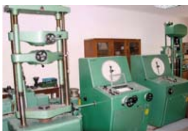
Sprzęt do badań quasi-statycznych elementów konstrukcyjnych
