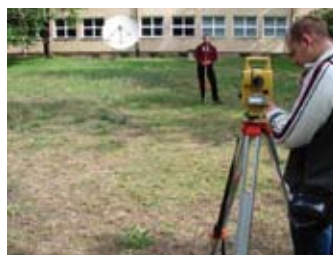
Pomiary kalibracyjne zestawów tachimetrów elektronicznych
