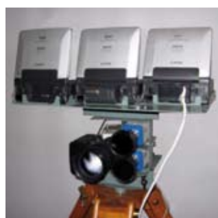
Zestawy do pozyskiwania zobrażeń wielospektralnych 5-kanalowy i 4-kanalowy
