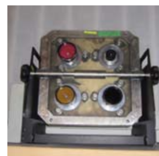
Zestawy do pozyskiwania zobrażeń wielospektralnych 5-kanalowy i 4-kanalowy
