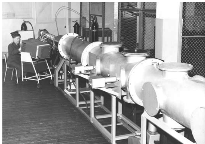
Pplk Marian Czeladzki przygotowujący badania przebijalności osłon balistycznych z wykorzystaniem stanowiska z hiperdźwiękowym układem miotającym
