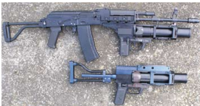
Granatnik podwieszany GPBO-40 oraz samodzielny GSBO-40, wchodzące w skład Systemu Broni i Amunicji Obezwładniającej SBAO-40
