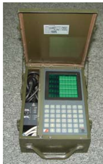
Specjalizowany kalkulator artyleryjski SKART do 152 mm armatohaubicy wz. 1977 DANA
