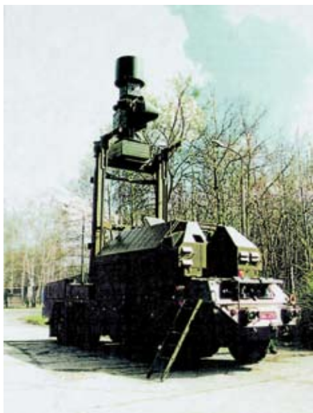
Naziemna stacja rozpoznania radioelektronicznego (prod. PIT)
