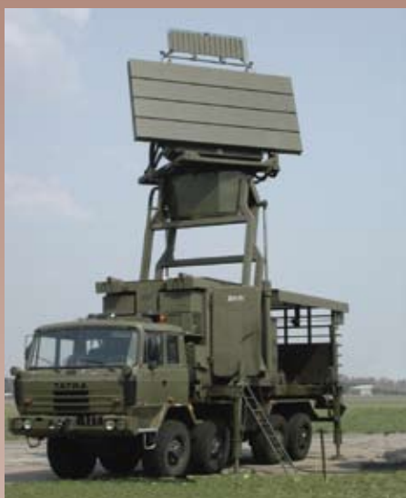
Zdj. 2. Radar 3D średniego zasięgu ze stosem wiązek do odbioru i obracającym się systemem antenowym w postaci szyku fazowanego; producent – PIT
