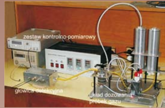
Zdj. 5. Stanowisko do badań detektora gazów (elektronicznego nosa)
