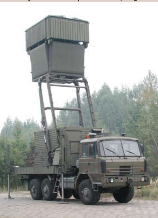
Zdj. 1. Radar trójwspółrzędny (3D) z elektronicznym przeszukiwaniem przestrzeni obserwacji wiązkami ołówkowymi; producent – PIT
