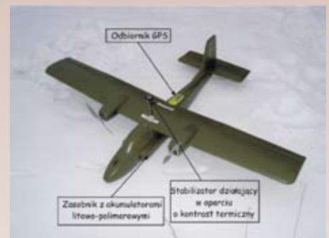
Zdj. 6. Widok ogólny mini-BSL z kamerą światła dziennego na pokładzie. Mini-BSL ma dwusilnikowy napęd elektryczny
