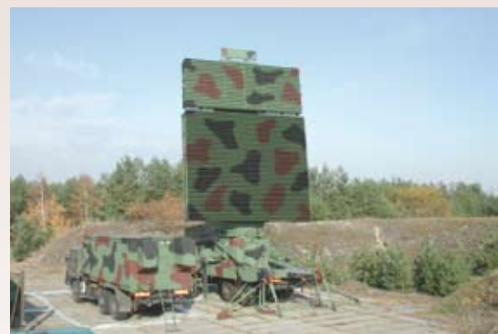
Zdj. 3. Radar 3D dużego zasięgu ze stosem wiązek do odbioru i obracającym się systemem antenowym w postaci szyku fazowanego; producent – PIT
