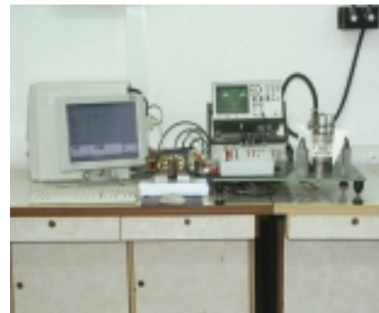
Model symulacyjny rakiety samonaprowadzającej się z włączonym fizycznym elementem aparatury naprowadzania (autopilotem)
