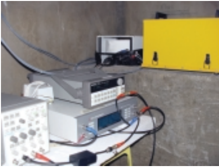
Sejsmograf rotacyjny zbudowany przez Zespół Badawczy Nielekunikacyjnych Zastosowań Światłowodów
