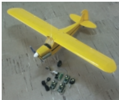
Cyfrowy system sterowania lotem bezpilotowego statku powietrznego
