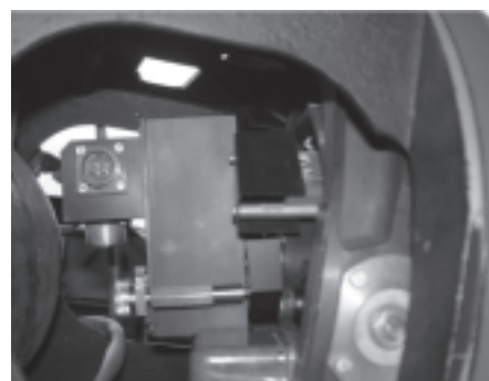
Moduł detekcyjny w głowicy samonaprowadzającej rakiety P22.
