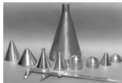
Spiekane wkładki kumulacyjne wytworzone za pomocą technologii opracowanej przez Zespół .
