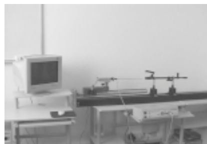
Stanowisko do nieniszczącego badania trwałości luf małych kalibrów za pomocą boroskopu.
