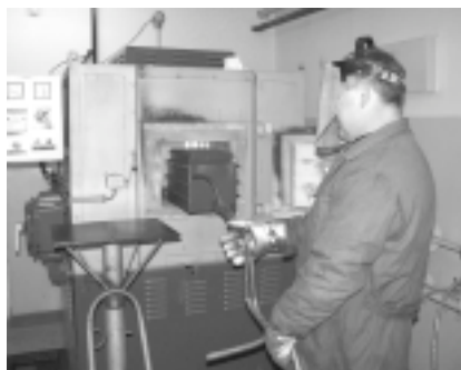
Piec do spiekania w atmosferze ochronnej.
