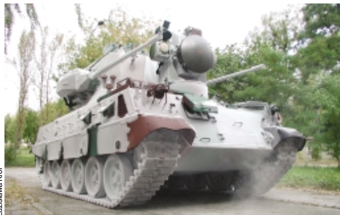
Oszroniony PZA LOARA po wyjeździe z komory niskich temperatur (z temp. -30^{\circ}\text{C} ).
