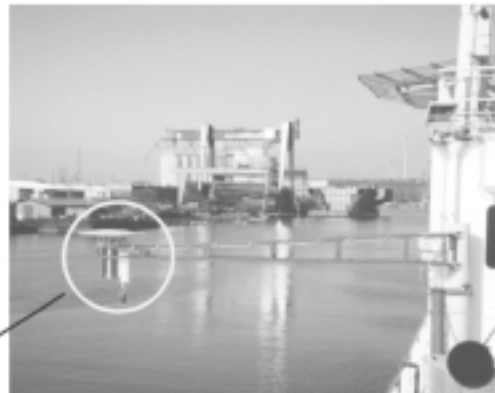
Pirometr do zdalnego pomiaru temperatury wody morskiej zamontowany na statku badawczym. Rozdzielczość pomiaru temperatury wynosi 0.01°C. Precyzyjne pomiary temperatury powierzchni wody wspomagają metody poszukiwania ropy naftowej pod dnem morskim.
