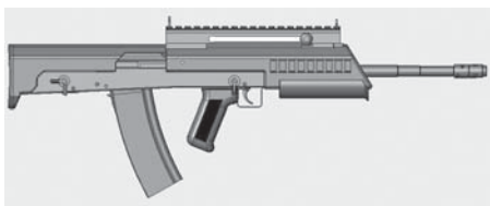
Projekt koncepcyjny karabinka wz. 1996 w układzie bezkolbowym (sierż. pchor. Łukasz Szmít).
