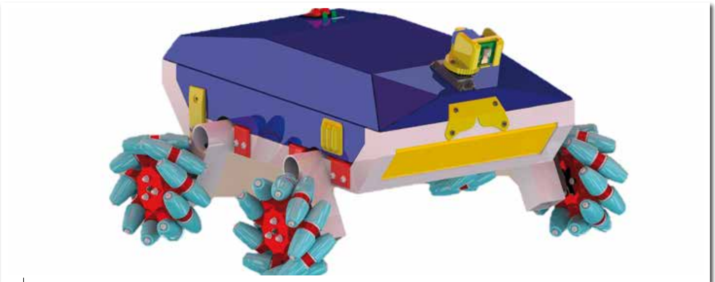
Robot mobilny sterowany bezprzewodowo z systemem wizyjnym oraz układem jezdny omnidirectional
