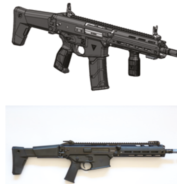
Subkarabinek w kolbowym układzie konstrukcyjnym jest „skróconą” odmianą 5,56 mm karabinka standardowego (podstawowego) MSBS GROT, w której zastosowano lufę o długości 264 mm. Dzięki temu broń jest bardzo kompaktowa, co sprawia, że doskonale nadaje się do walki w ciasnych przestrzeniach
