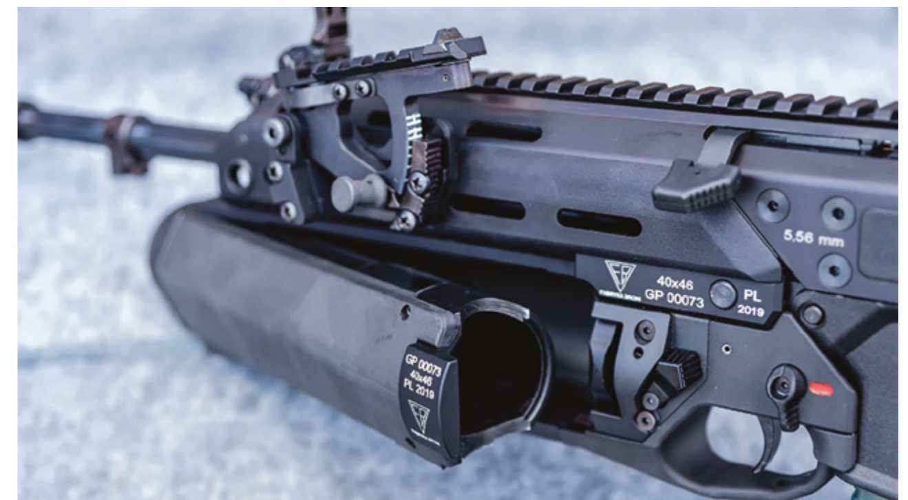
Granatnik podwieszany do karabinka standardowego w pozycji do załadowania naboju
