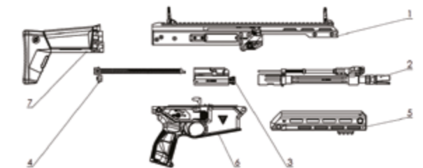
Główne zespoły 5,56 mm subkarabinka w układzie kolbowym: 1 – komora zamkowa, 2 – lufa, 3 – zespół suwadła z zamkiem, 4 – urządzenie powrotne, 5 – łożo, 6 – komora spustowa, 7 – kolba teleskopowa
