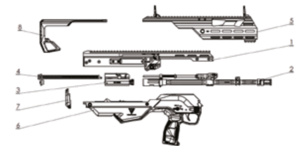
Główne zespoły karabinka podstawowego w układzie bezkolbowym: 1 – komora zamkowa, 2 – lufa, 3 – zespół suwadła z zamkiem, 4 – urządzenie powrotne, 5 – łożo (nakładka), 6 – komora spustowa, 7 – łącznik komór, 8 – trzewik
