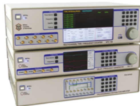
Wielofunkcyjny system pomiarowy do precyzyjnej metrologii czasu opracowany w WAT
