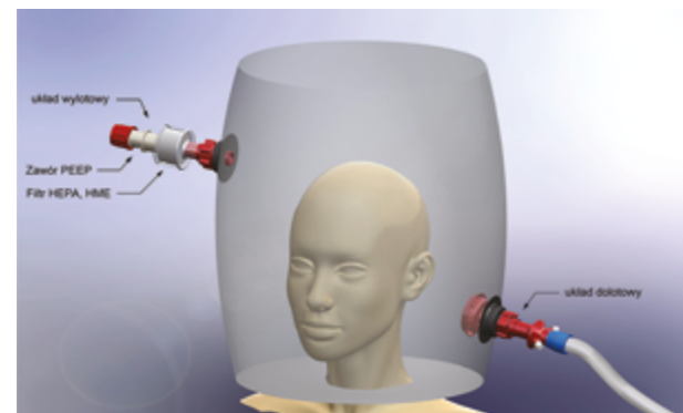
Widok ogólny projektowanego hełmu wspomagającego oddychanie
