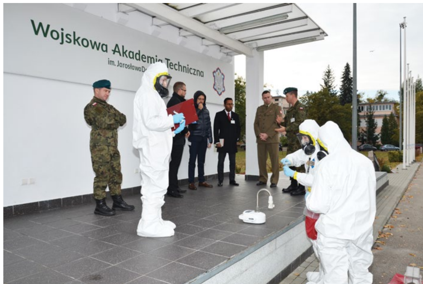
Pobór próbki z próbnika powietrza
