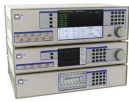
Opracowany w zespole badawczym ZTC WEL WAT System pomiarowy do precyzyjnej metrologii czasu i częstotliwości
