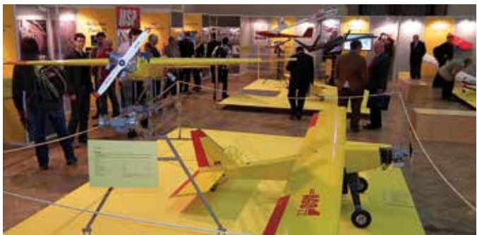
Na pierwszym planie znajdujący się na wyposażeniu Instytutu Optoelektroniki WAT płatowiec do przenoszenia aparatury naukowo-badawczej, sensorów pomiarowych lub głowic obserwacyjno-pomiarowych
