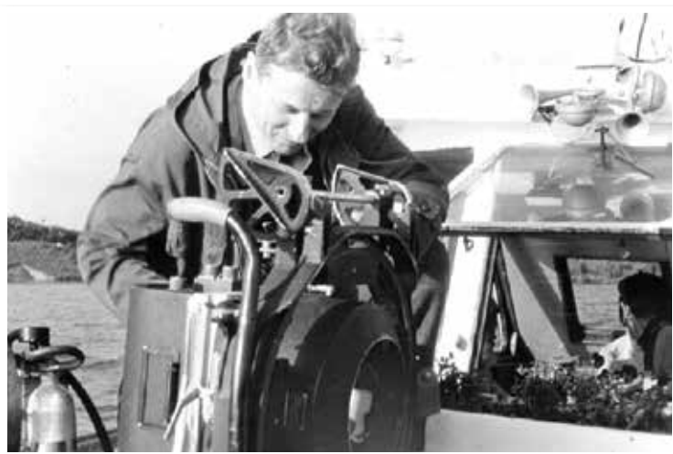
Mjr Jerzy Butowtt wykonuje fotogrametryczne zdjęcia nawodne skarpy brzowej adaptowaną amerykańską lotniczą kamerą fotogrametryczną z pokładu statku
