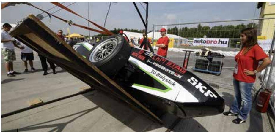
Sprawdzenie szczelności układów pojazdu. Na zdjęciu pojazd zespołu Politechniki Białostockiej
