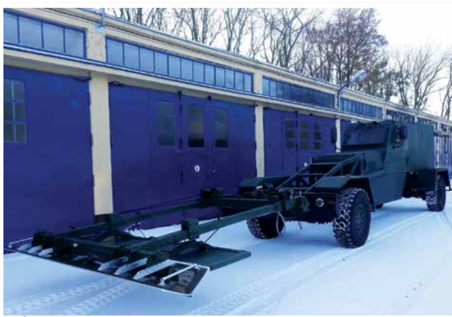
Pojazd rozpoznania dróg Shiba w wersji z rozłożonym georadarem i wykrywaczem indukcyjnym
