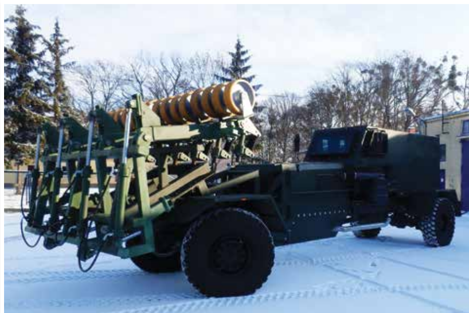
Pojazd rozminowania dróg z min i IED Shiba ze złożonym trałem naciskowym
