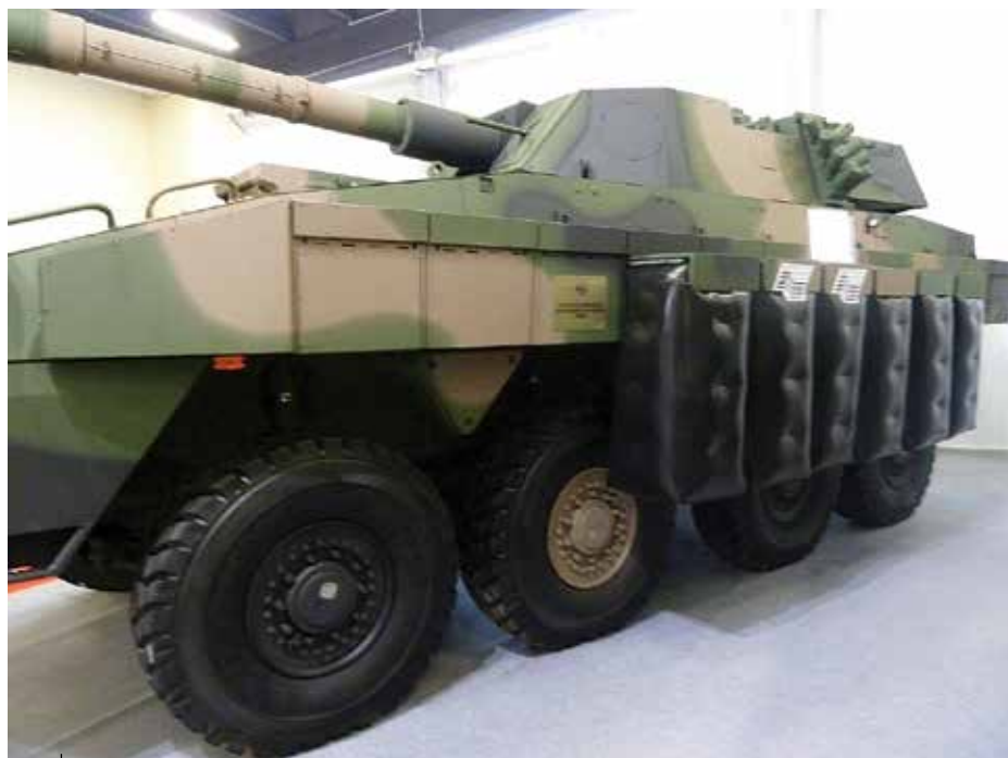
Pojazd „Wilk”, wóz wsparcia ogniowego na podwoziu KTO „Rosomak”, wyposażony w wielofunkcyjne osłony, które zostały opracowane przez zespół naukowców z Wojskowej Akademii Technicznej, i na które nasza Alma Mater posiada patent
