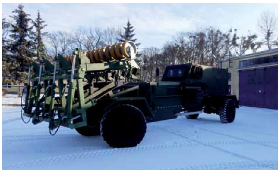
Pojazd rozminowania dróg z min i IED Shiba ze złożonym trałem naciskowym
