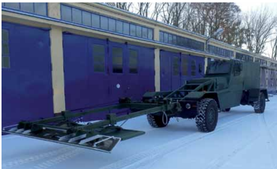
Pojazd rozpoznania dróg Shiba w wersji z rozłożonym georadarem i wykrywaczem indukcyjnym
