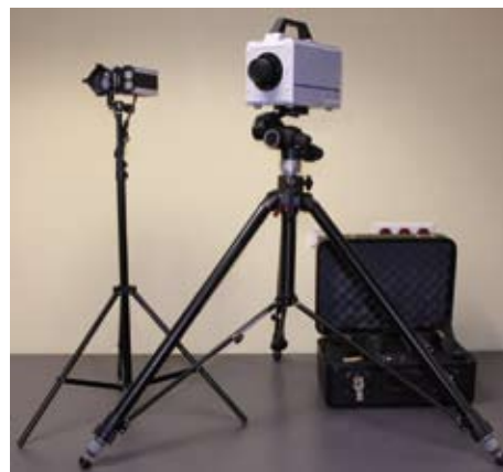
Kamera do rejestracji bardzo szybkich procesów. Laboratorium Techniki Obrazowej
