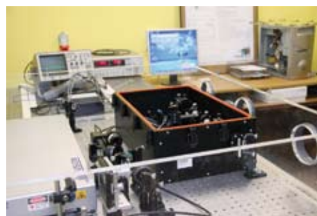
Spektrometr TDS z laserem femtosekundowym w Laboratorium Techniki Terahercowej
