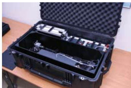
Przenośny optoelektroniczny czujnik NOx do monitoringu atmosfery
