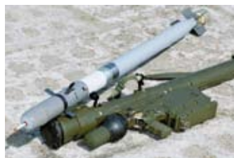
Pocisk raketowy wraz z wyrzutnią wyposażoną w mechanizm startowy oraz naziemną baterię zasilającą NBZ
