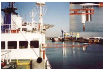
Pirometr do zdalnego pomiaru temperatury wody morskiej
