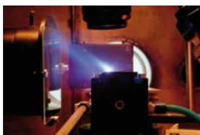
Zawór do wytwarzania dwustrumieniowej tarczy gazowej w komorze próżniowej
