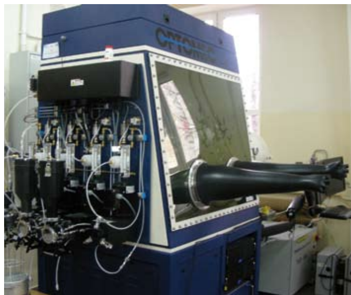
Stanowisko laboratoryjne do kombinatoryjnego wytwarzania i badania właściwości wodoroków w Katedrze Zaawansowanych Materiałów i Technologii
