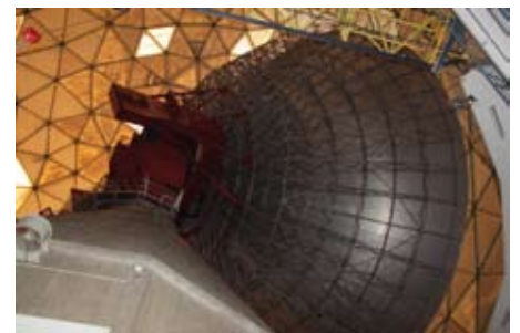
Antena radaru TIRA (ang. Tracking & Imaging Radar ) służącego do monitorowania przestrzeni kosmicznej, w tym śledzenia satelitów oraz innych obiektów kosmicznych
