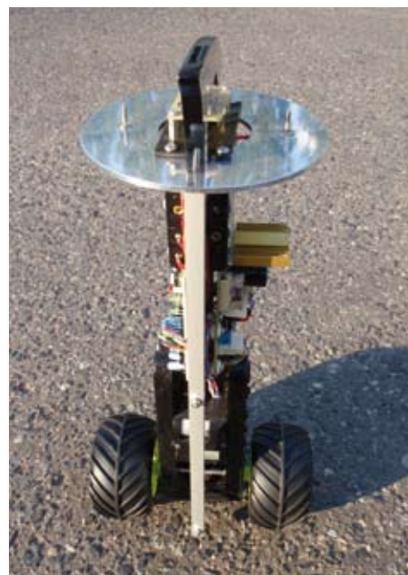
Model mobilnej platformy dwukołowej realizującej wahadło odwrócone
