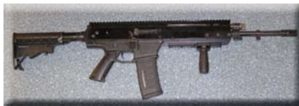
Model badawczy demonstratora technologii karabinka podstawowego zbudowanego w kolbowym układzie konstrukcyjnym (widok z prawej strony)
