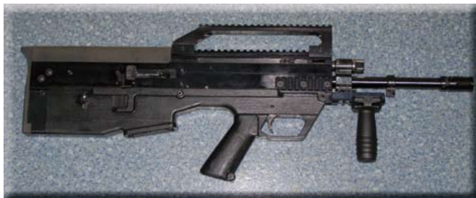
Model badawczy demonstratora technologii karabinka zbudowanego w bezkolbowym układzie konstrukcyjnym (widok z prawej strony)
