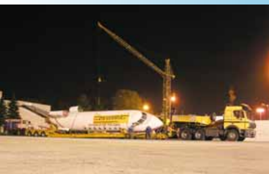
Po obróceniu na bok – w celu obniżenia wysokości ładunku – kadłub gotowy do transportu do Akademii
