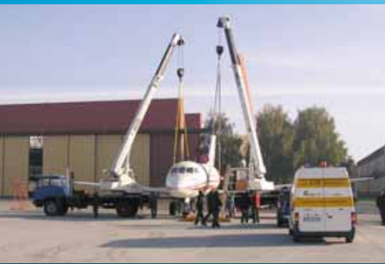
Początek operacji: podnoszenie samolotu i przygotowanie go do załadunku
