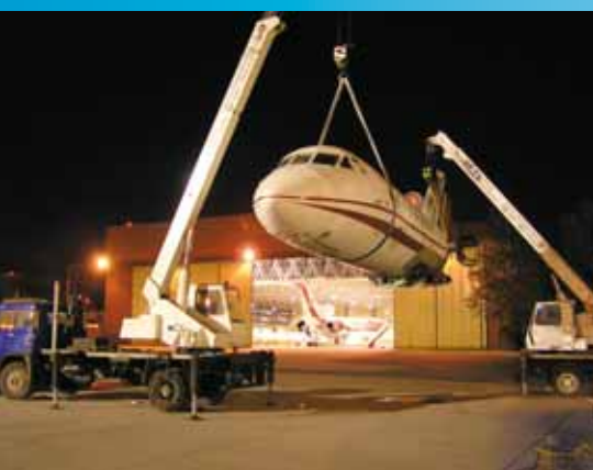
Po kilkunastu godzinach pracy ostatecznie oddzielono kadłub od skrzydeł
