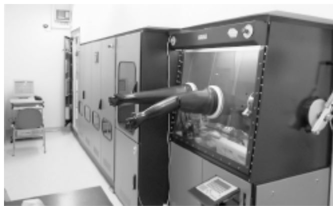
System Aix-200 II-VI zainstalowany w Laboratorium MOCVD VIGO/WAT.
