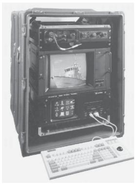
System transmisji kodowanych danych obrazowych ze statku powietrznego.
